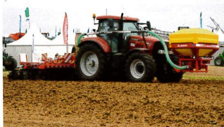
Универсальная сеялка, подходит для высева зерновых и промежуточных культур, внесения гранулированных минеральных удобрений или микрогранул. Сеялка «FRONT-TURBO» устанавливается на переднюю навеску трактора. Норма высева автоматически управляется компьютером Seeder+. Предусмотренные объемы бункеров для «FRONT-TURBO» – 1000, 1200 и 2000 литров. Ширина захвата – от 3 до 15 метров.
